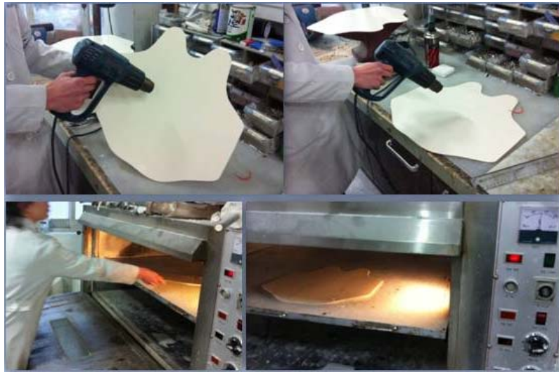
〔그림 13〕 흥요천추보조기의 앞판 및 등판 열성형 가공
